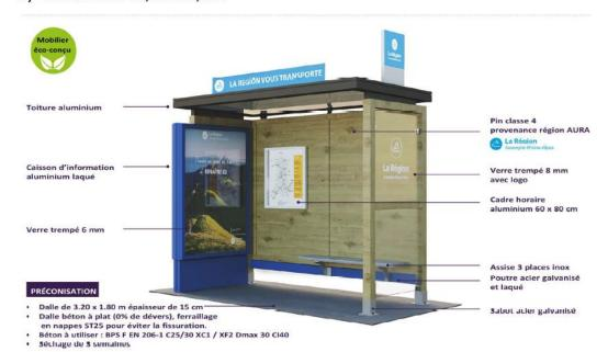
Cet abri nécessite une dalle béton de 3,20m x 1,80m, épaisseur 15cm et une légère rampe d'accès. La mise en œuvre de la dalle et l'électrification éventuel de l'abris appartient à la collectivité. Pour les dalles béton, le ferraillage à utiliser est un treillis de structure standard type ST25
